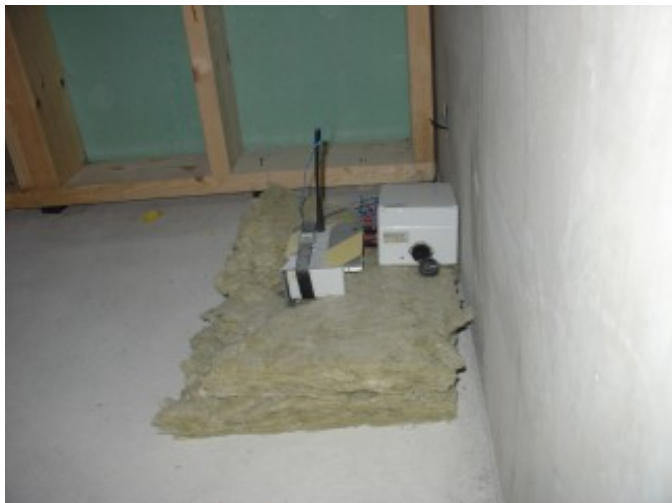
Figur 9. Mät punkt S2, isolerad med mineralull, till vänster, datalogger för temperatur till höger
