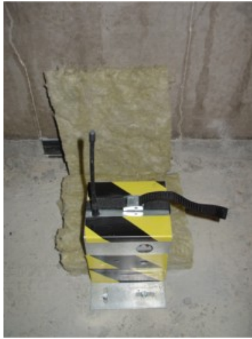
Figur 10. Mät punkt S5, med 45 mm isolering, med utbredning på 200 mm * 200 mm
