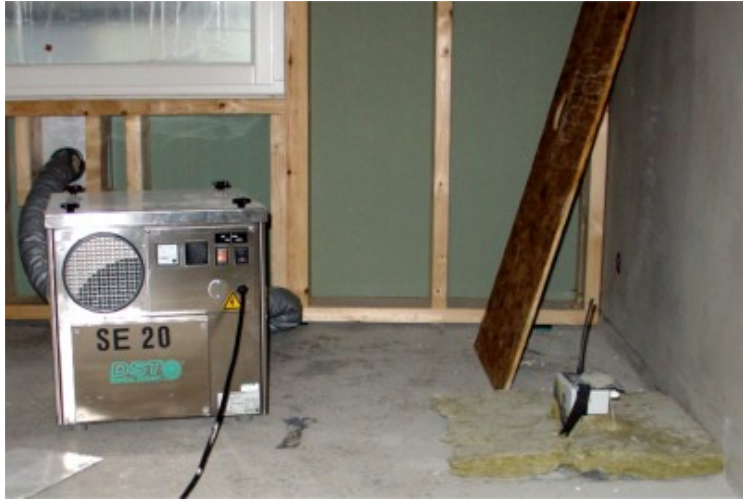
Figur 8. Mät punkt S1, plan 1, till höger i bild, sorptionsavfuktare till vänster
