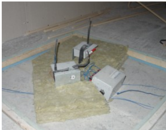
Figur 6. Mätpunkt M3, närmast kameran till vänster, mätpunkt M4 längst bort från kameran samt datalogger för temperatur
