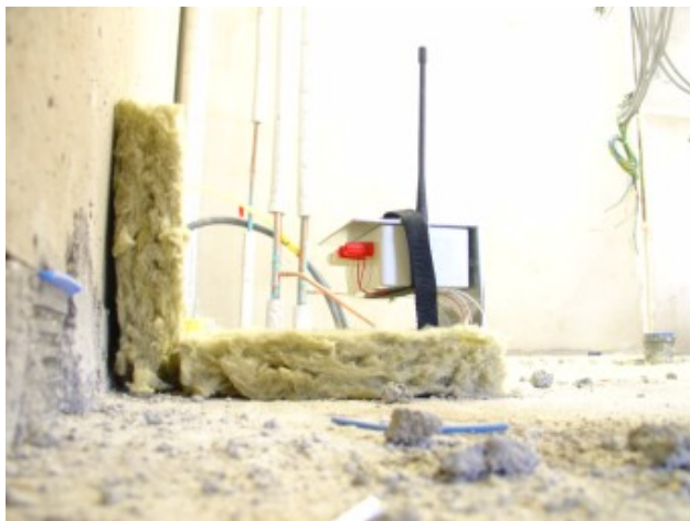
Figur 11. Mät punkt S6, med 45 mm isolering, utbredning 200 mm * 200 mm
